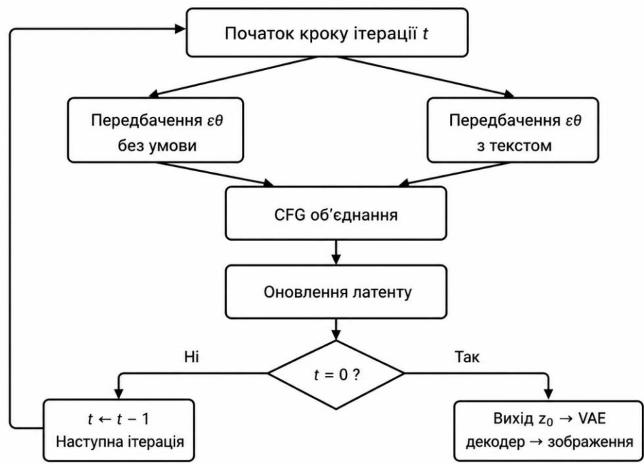
Рисунок 2.2 – Крок ітерації семплера з паралельними передбаченнями для CFG та циклом до завершення
