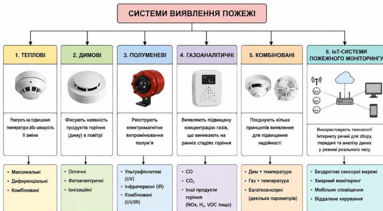
Рисунок 1.1. - Класифікація систем виявлення пожежі
