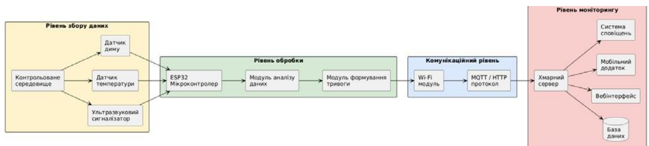
Рисунок 2.1 - Структурна схема системи моніторингу пожежі
