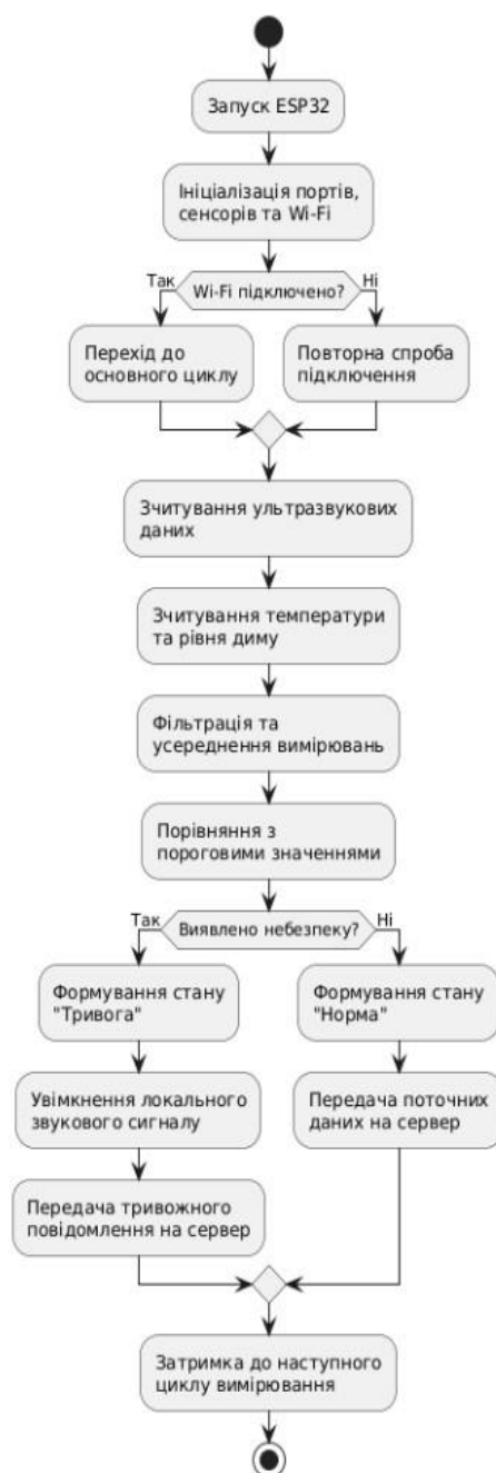
Рисунок 3.5 - Алгоритм роботи програмного забезпечення мікроконтролера
