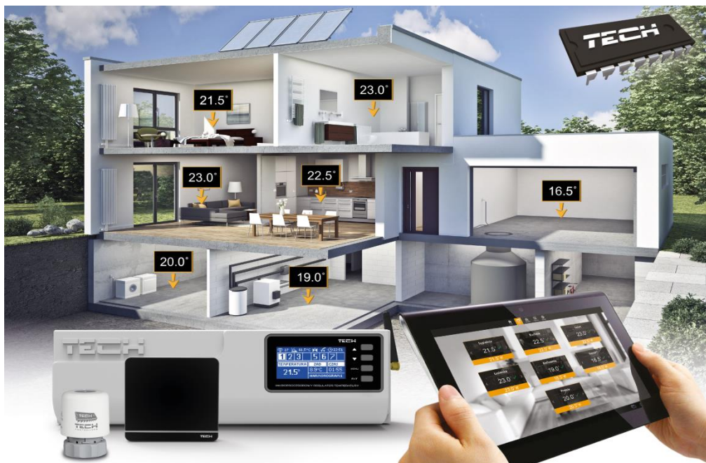
Рисунок 1.5 – Компонівка автоматизованої системи керування обігрівом у складі комплексу «розумний будинок»
