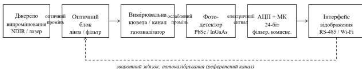
Рисунок 2.2 – Деталізована структура оптичної системи
