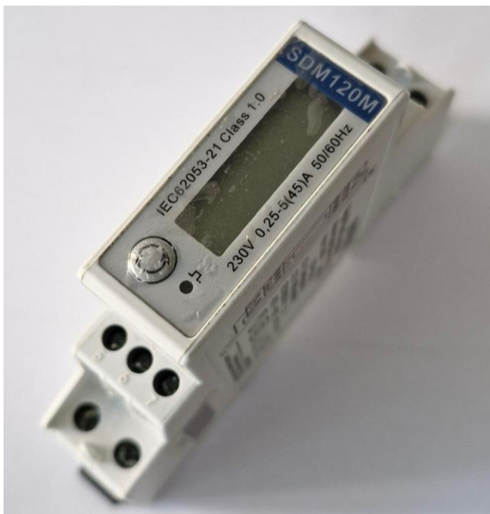
Рисунок 2.4 — Однофазний смарт-лічильник Eastron SDM120M
