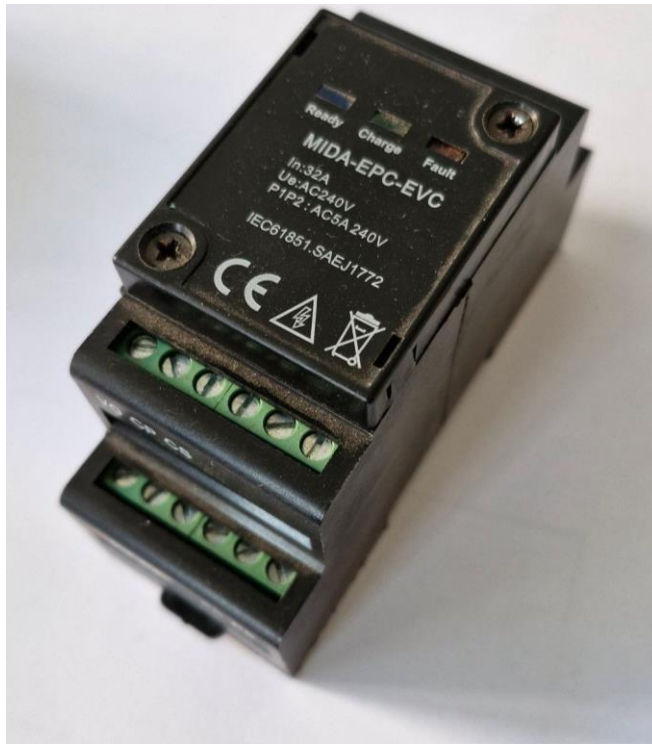
Рисунок 2.5 Спеціалізований контролер протоколу зарядки MIDA-EPC-EVC
