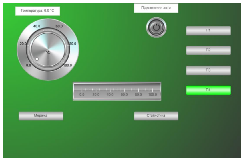
Рис 3.12. Візуалізація стану блокування інтерфейсу при переході системи в аварійний режим
