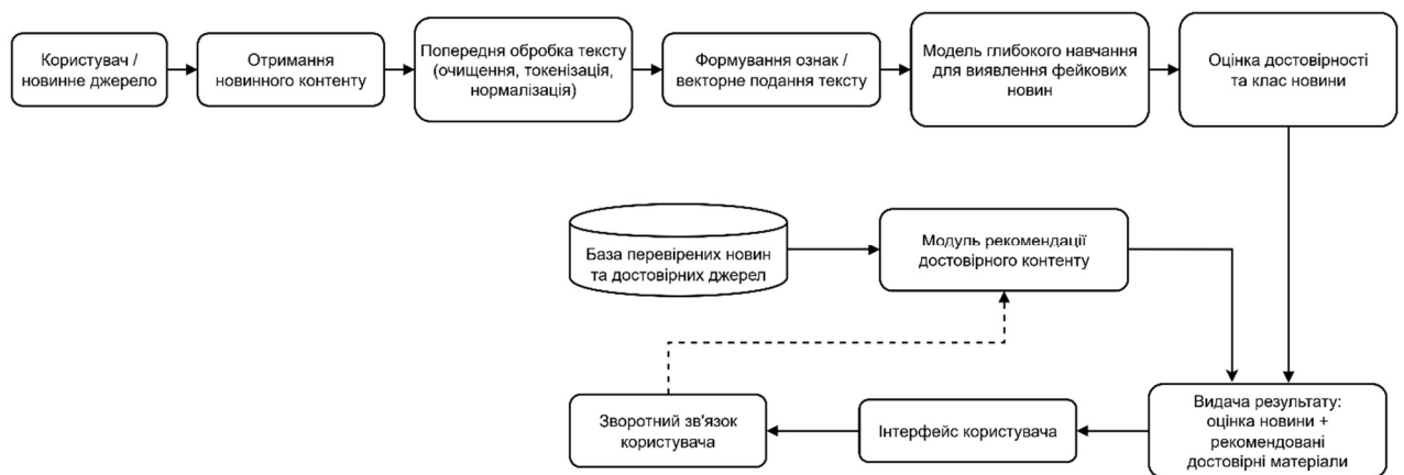
Рисунок 2.1 – Архітектура програмного модуля виявлення фейкових новин та рекомендації достовірного контенту
