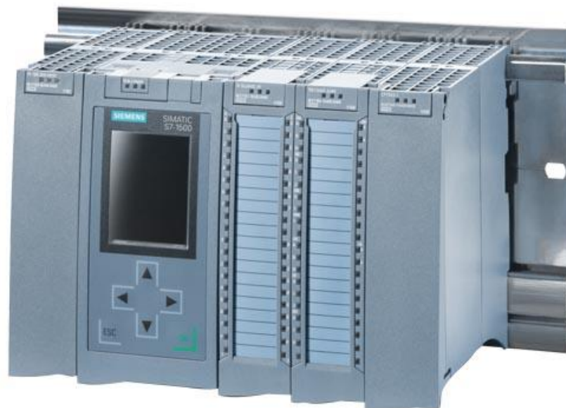
Рисунок 2.5 – Загальний вигляд ПЛК Siemens SIMATIC S7-1500
