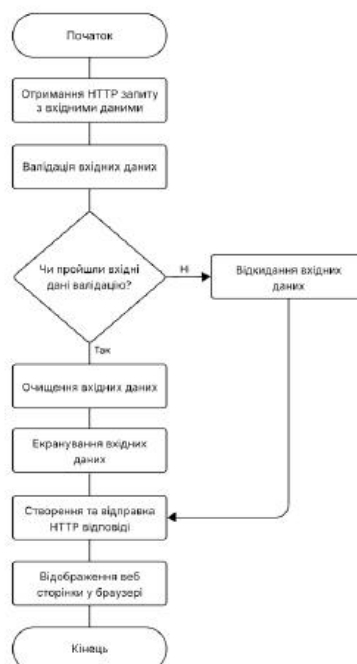
Рис.2. Схема алгоритму протидії XSS атаки
