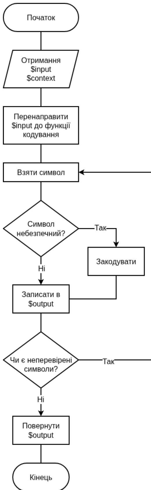
Рисунок 3.10 – Схема алгоритму протидії XSS вразливостям через екранування даних
