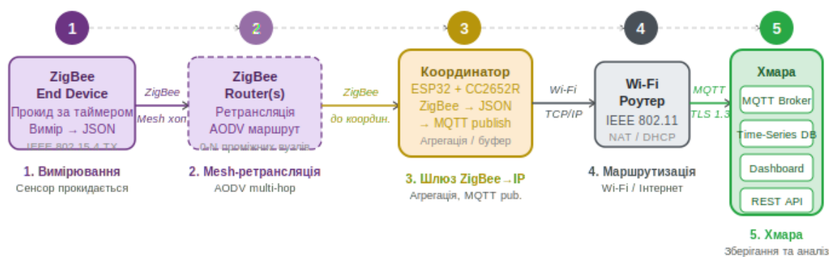
Рисунок 3.3 — П'ятистадійний процес передачі даних сенсорного вузла
