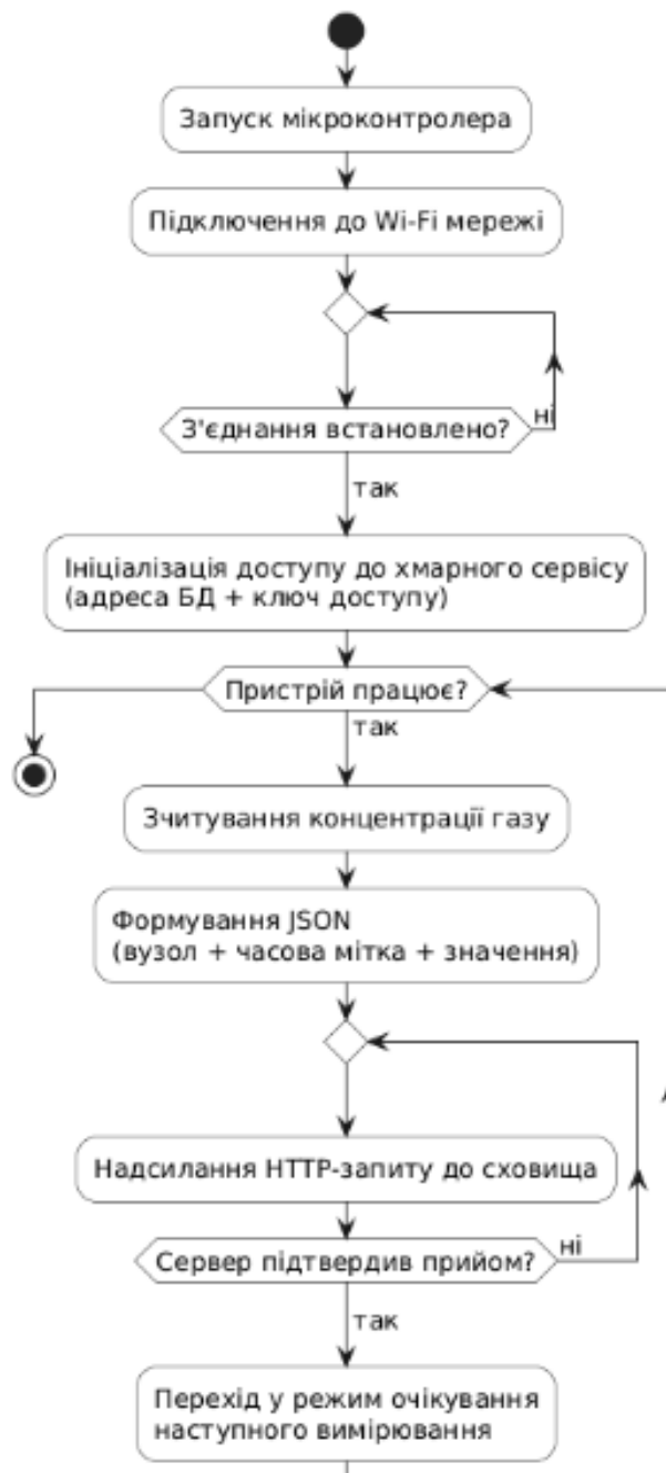
Рисунок 3.7 - Блок-схема роботи системи з хмарним середовищем
