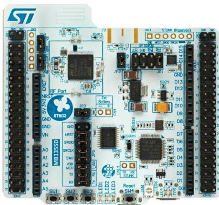
Рисунок 2.5 - Плата розробки NUCLEO-WB55RG
