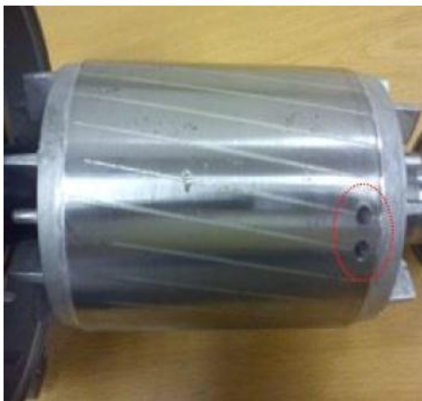
Рисунок 4.3 – Ротор із двома пошкодженими стрижнями
