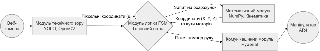
Рисунок 2.4 – Структурна схема програмного забезпечення та потоків даних
