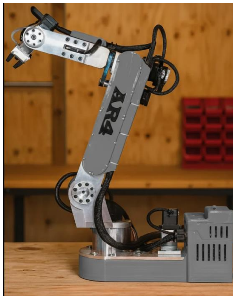
Рисунок 1.1 – Загальний вигляд 6-осьового маніпулятора відкритої архітектури Annin Robotics AR4
