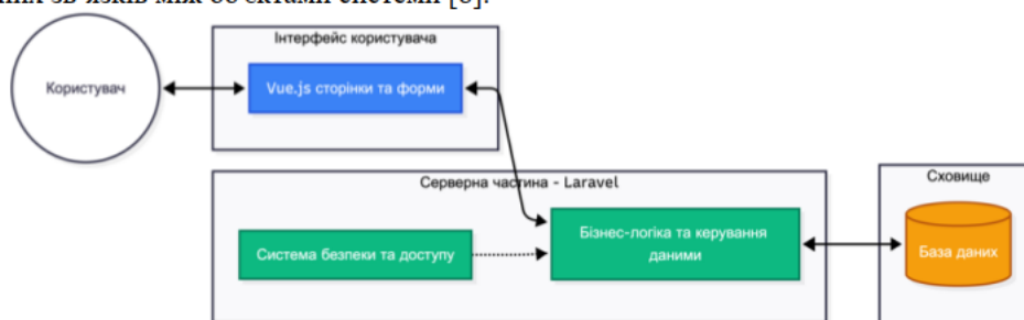
Рисунок 1. Структурна схема взаємодії компонентів CRM-системи
