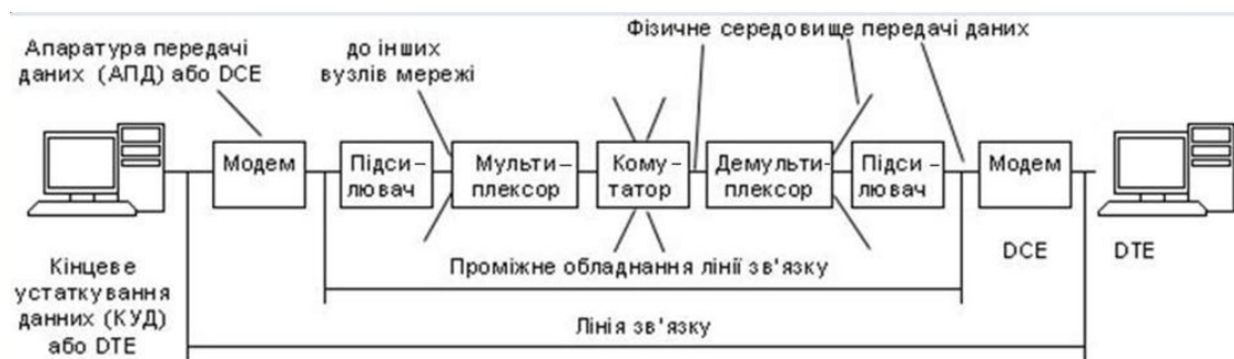
Рис. 3.4. Система передачі даних в ТМ на прикладі «КАРДІОТЕСТ-01» [14].
