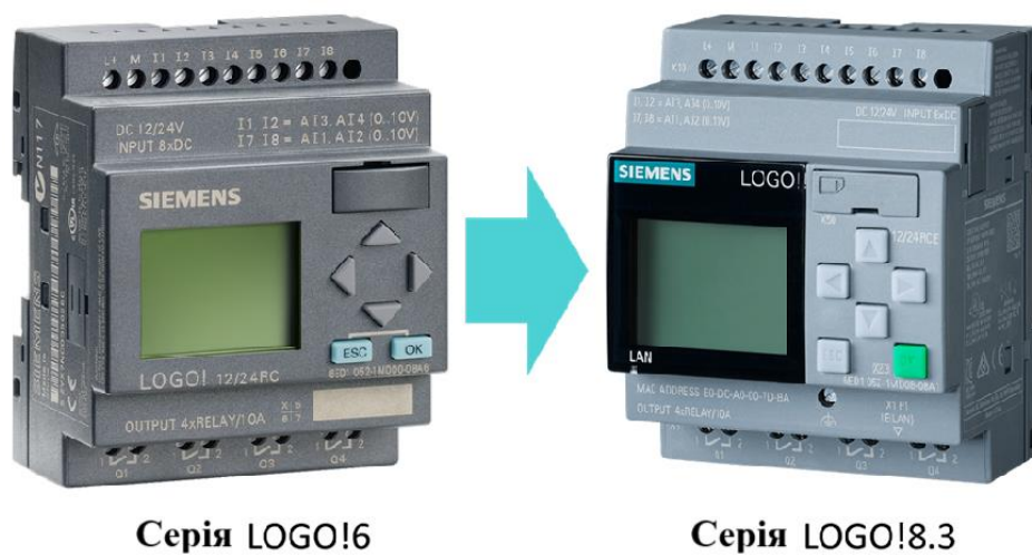
Рисунок 1.2 – Промисловий ПЛК орієнтований під задачі керування сонячного колектора
