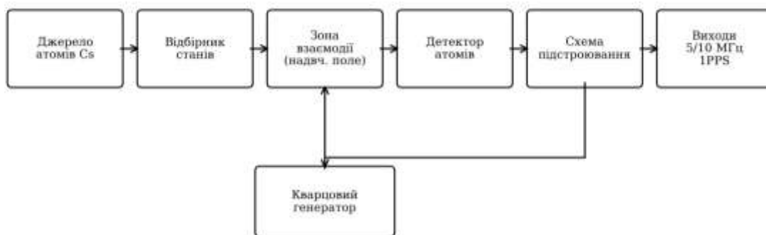
Рисунок 1.2 — Структурна схема цезієвого стандарту частоти
