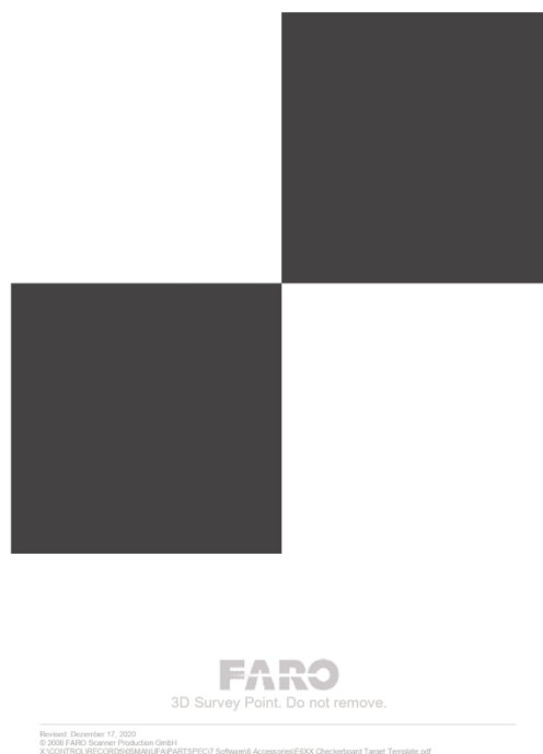
Рис. 3.7. Сканерна марка (опознак)
