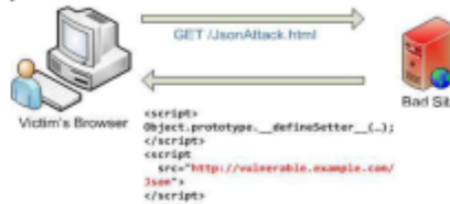
Рисунок 5. Схема виконання JSON Hijacking
