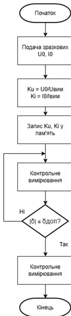
Рисунок 2.1 – Блок-схема алгоритму калібрування вимірювального каналу
