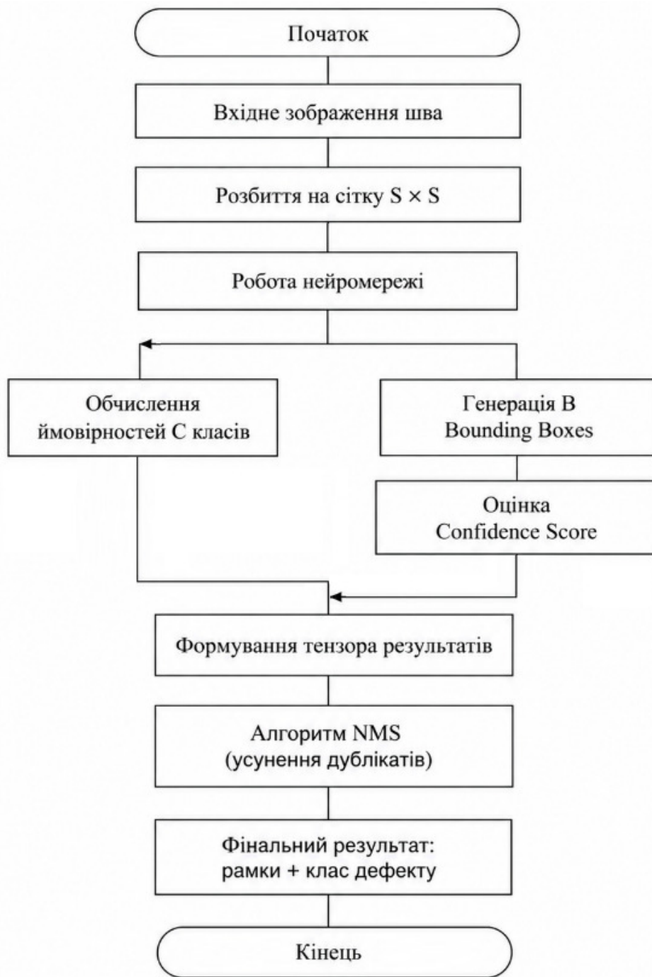
Рисунок 2.5 – Алгоритм виявлення дефектів зварного шва
