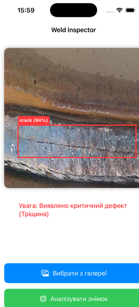
Рисунок 3.6 – Результат аналізу дефектного зварного шва (успішне виявлення тріщини)
