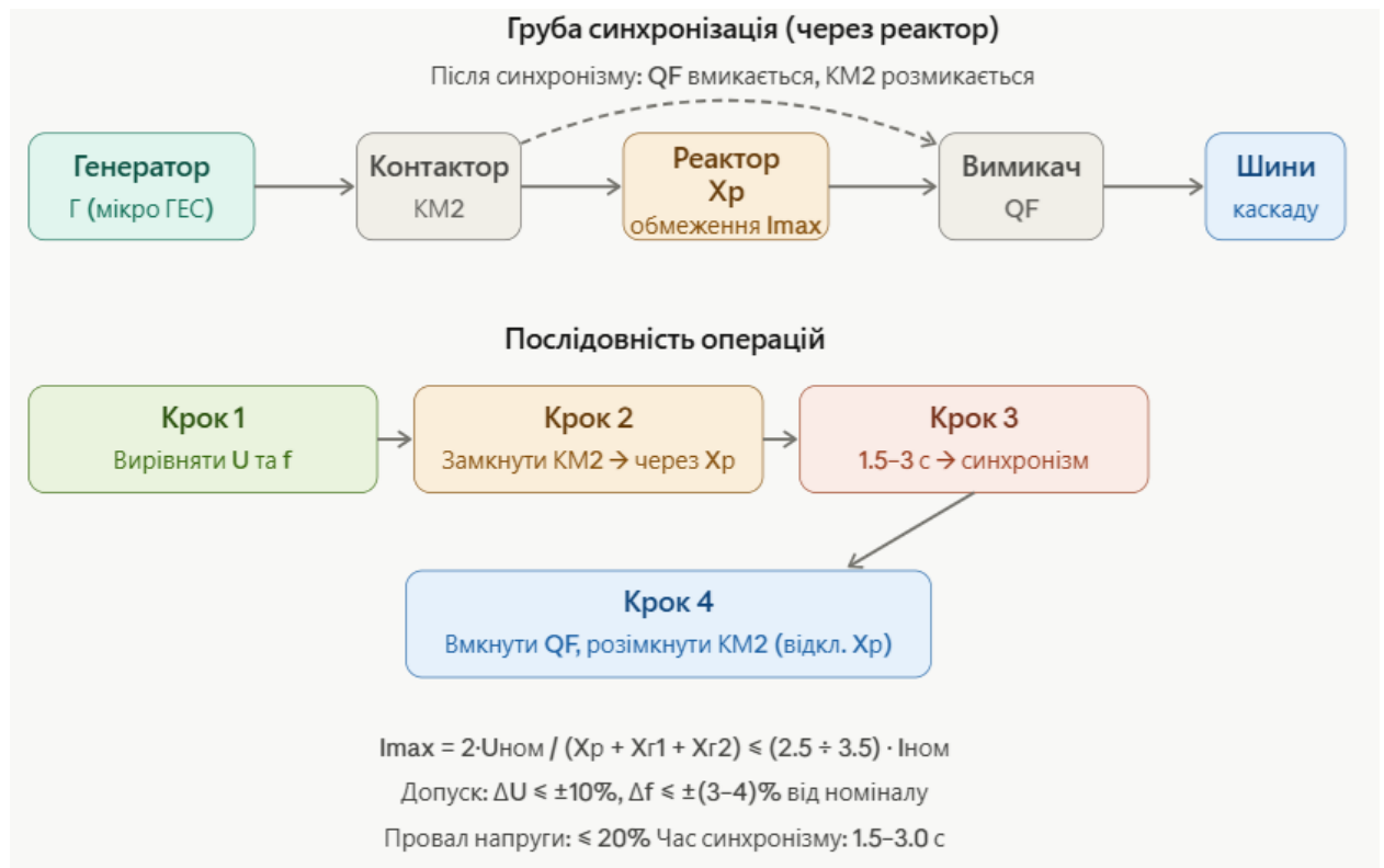
Рисунок 1.3 – Структурна схема та послідовність операцій підключення генератора ГЕС методом грубої синхронізації
