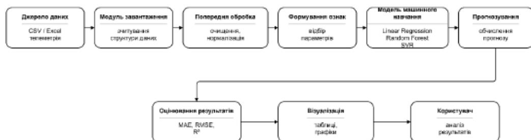
Рисунок 1 – Архітектура програмного модуля прогнозування енергоспоживання IoT-пристроїв
