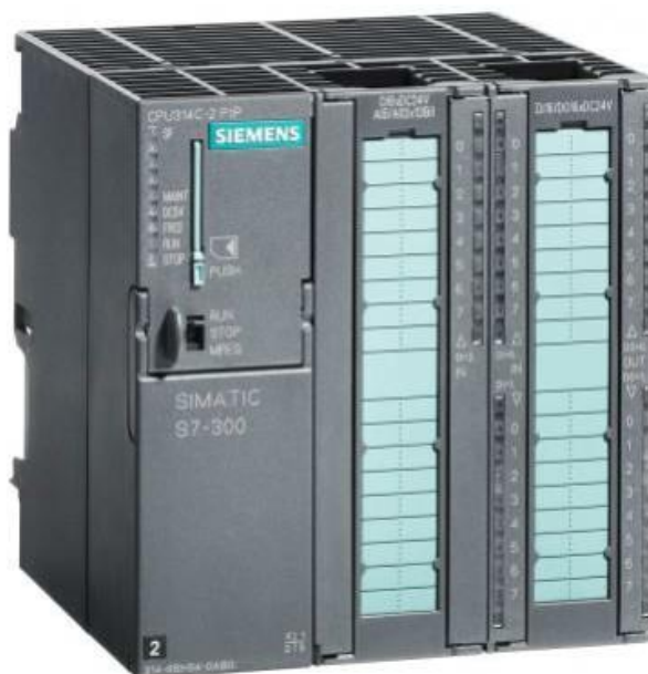
Рисунок 2.4 – Загальний вигляд ПЛК Siemens SIMATIC S7-300
