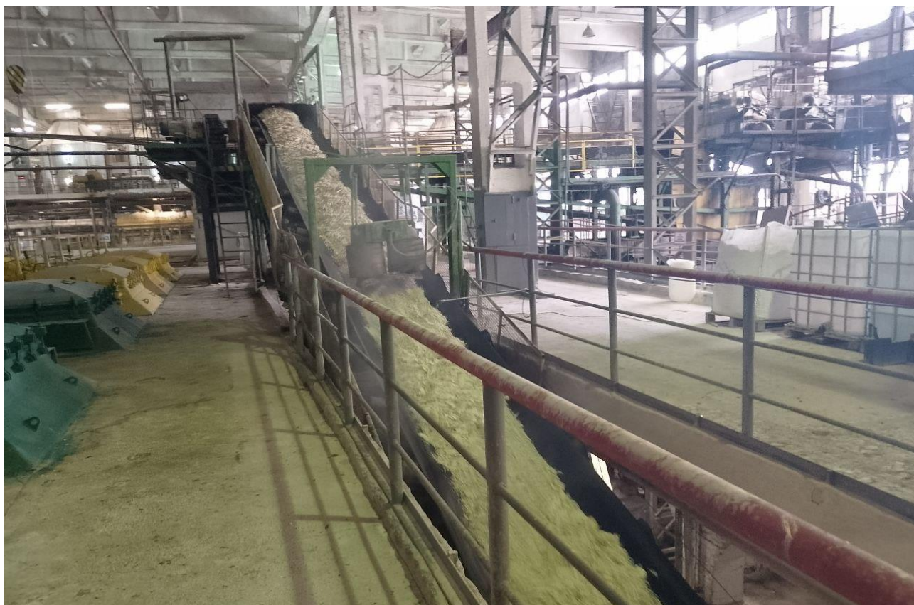
Рисунком 1.6 – Елеватор з буряковою стружкою. Збараський цукровий завод. Ліворуч блоки фільтрів МВЖ для згущення суспензії
