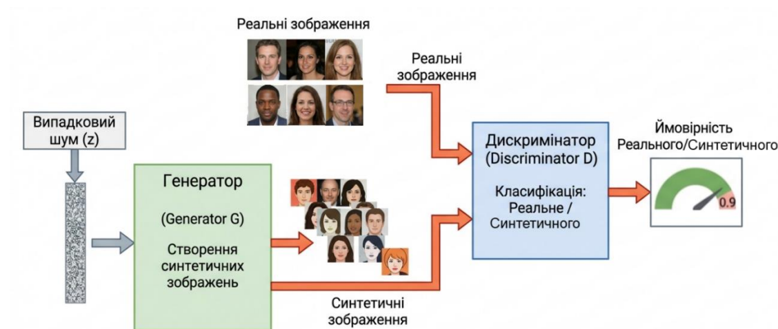
Рисунок 1.1 – Схема роботи генеративно–змагальної мережі (GAN)
