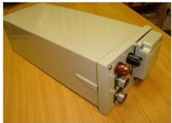
Рисунок 2.4 - Перетворювач ЕРС термопари в струм: а) схема (1 - підсилювач; 2 - блок лінеаризації; 3 - термопара); б) зовнішній вигляд;.
