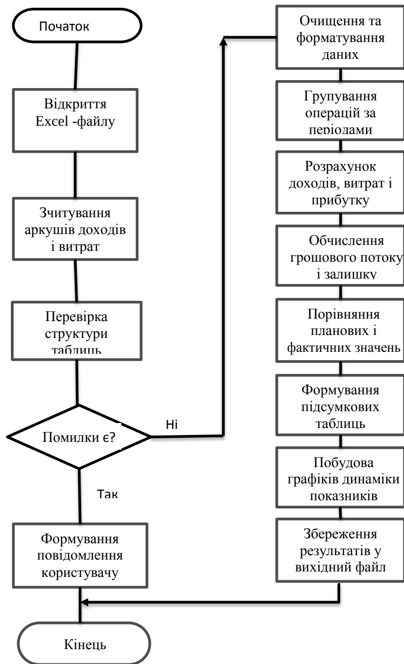
Рисунок 2.2 - Схема алгоритму автоматизованого фінансового аналізу мовою Python
