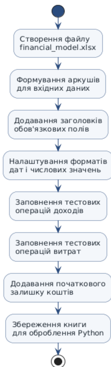
Рисунк 3.2 – Послідовність підготовки електронної книги до автоматизованого опрацювання
