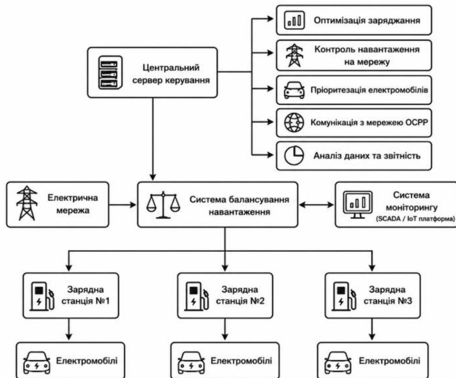
Рисунок 1.8 – Архітектура системи балансування навантаження зарядних станцій [15]
