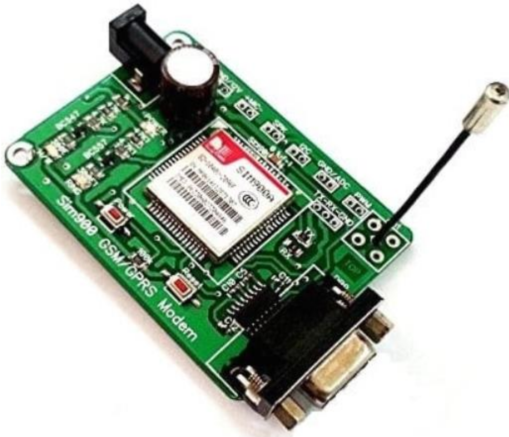
Рисунок 3.1 - GSM/GPRS модуль SIM900A
