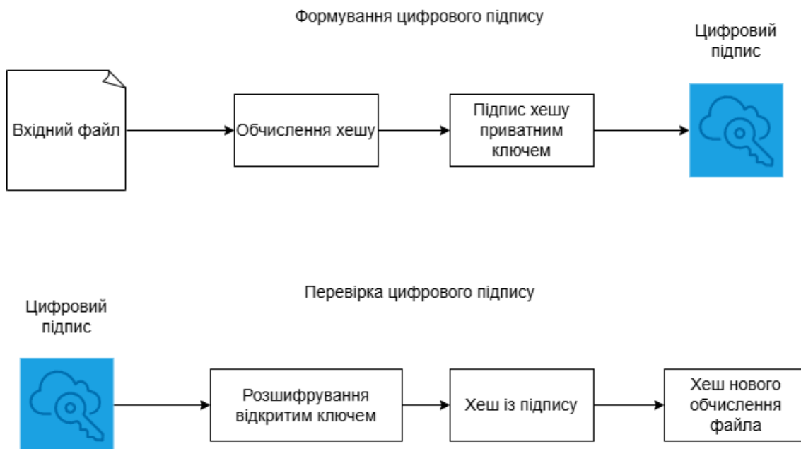
Рисунок 2.2 – Схема формування і перевірки цифрового підпису
