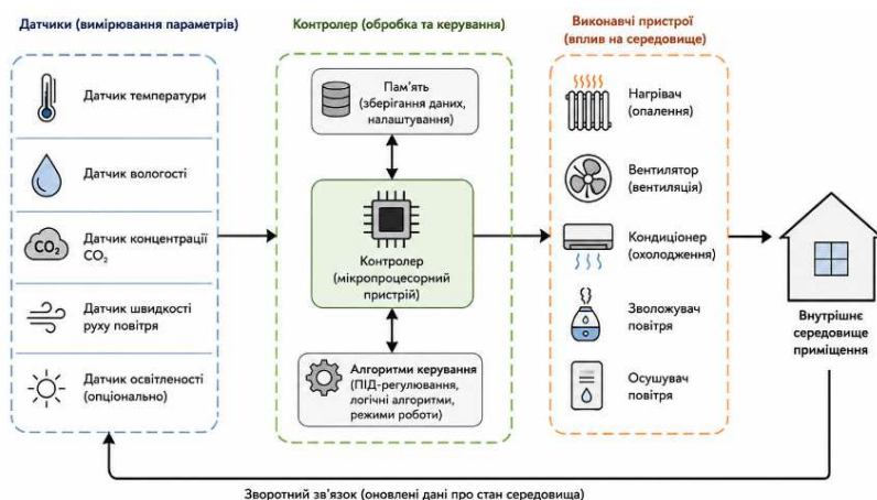
Рисунок 1.1 – Структурна схема автоматизованої системи керування мікрокліматом розумного будинку
