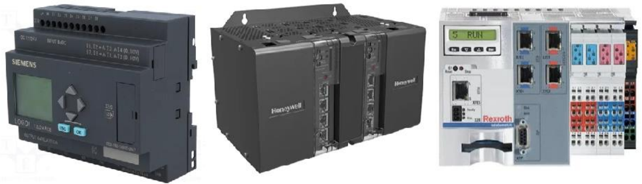
Рисунок 1.5 – Загальний вигляд найпопулярніших ПЛМ автоматизованих систем освітлення
