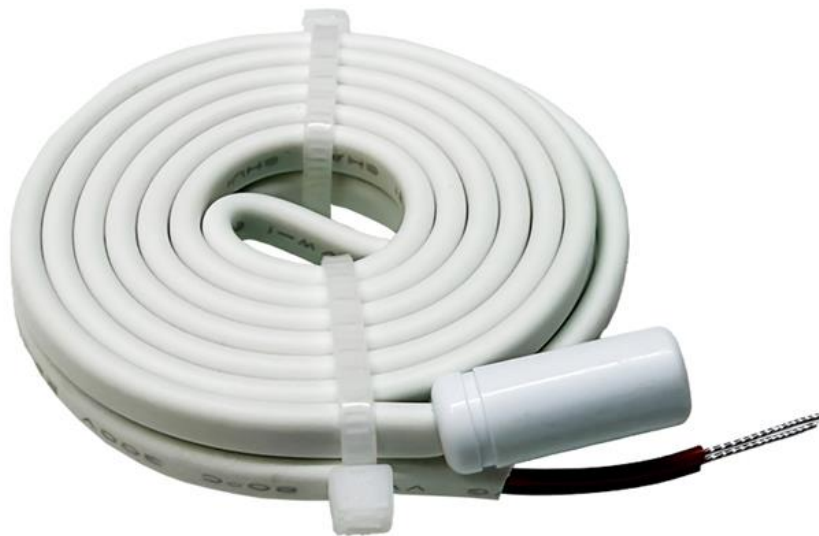
Рисунок 2.6 – Загальний вигляд цифрового сенсора температури DS18B20
