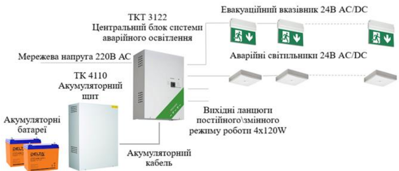
Рисунок 1.2 – Загальна структура автоматизованої системи аварійного освітлення
