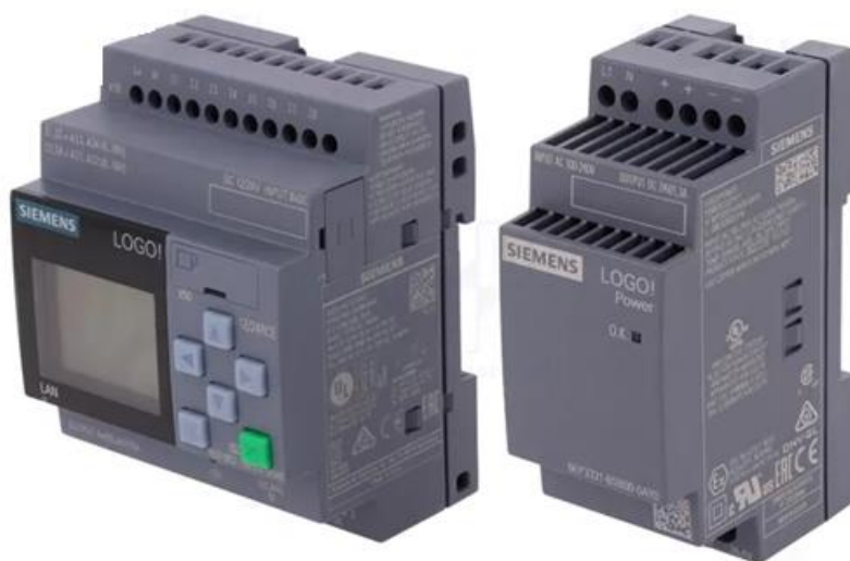
Рисунок 2.4 – Загальний вигляд ПЛК Siemens LOGO! 8
