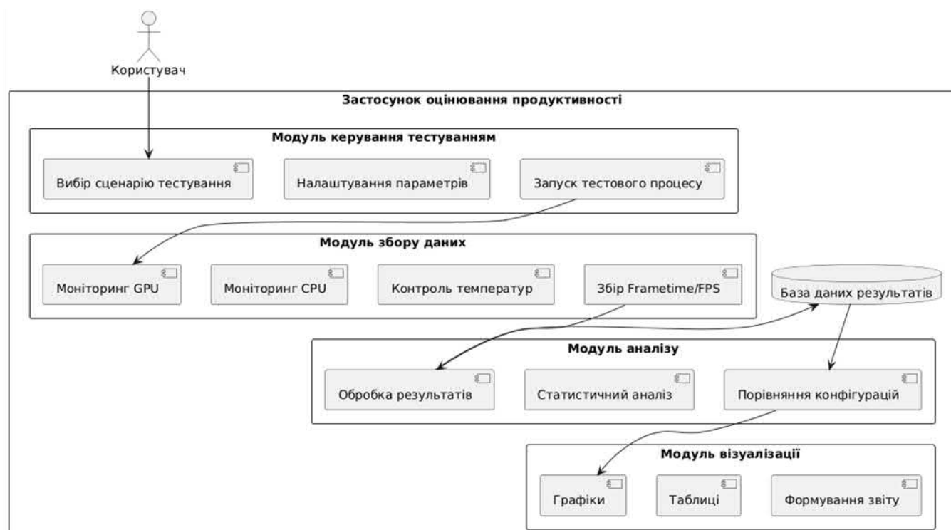
Рисунок 2.1 – Структура системного підходу до оцінювання продуктивності графічних прискорювачів
