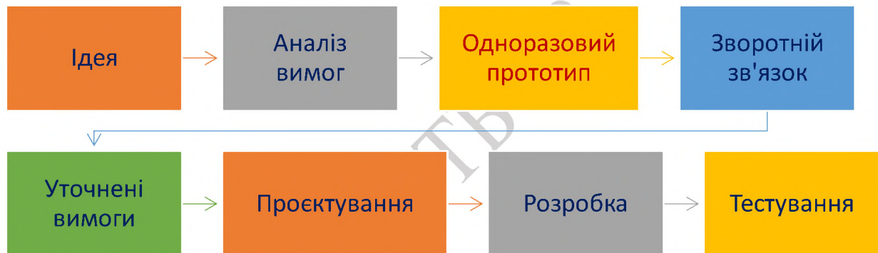
Рис.6.2. Схема життєвого циклу з одноразовим прототипом
