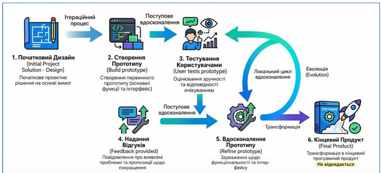
Рис.6.4. Ілюстрація ітераційного процесу еволюційного прототипування
