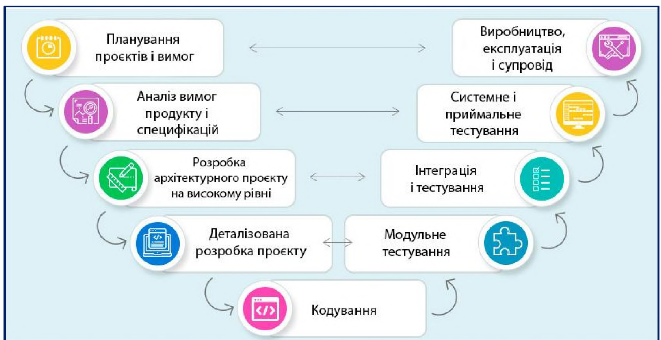
Рис.8.1. V-подібна модель розробки програмного забезпечення із плануванням тестування на ранній стадії проєкту
