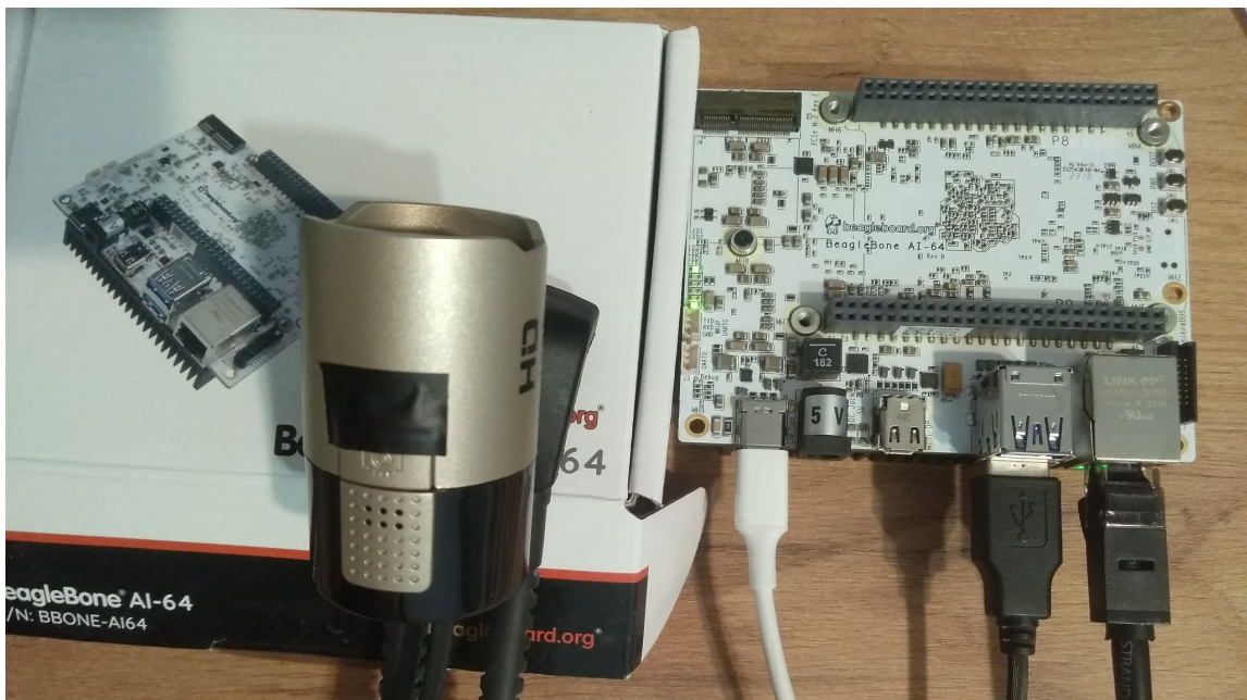
Рисунок 3.3 – Загальний вигляд апаратного стенда на базі BeagleBone AI-64 для виявлення та відстеження об'єктів
