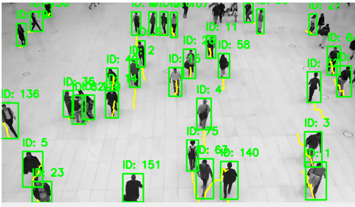
Рисунок 3.5 – Демонстрація роботи алгоритму відстеження: збереження ідентифікатора (ID) об'єкта та побудова траєкторії руху
