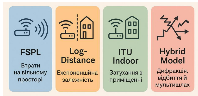
Рисунок 1.3 - Радіочастотні моделі та методи прогнозування покриття
