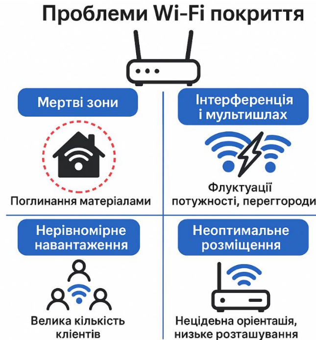
Рисунок 1.1 - Ключові проблеми Wi-Fi покриття
