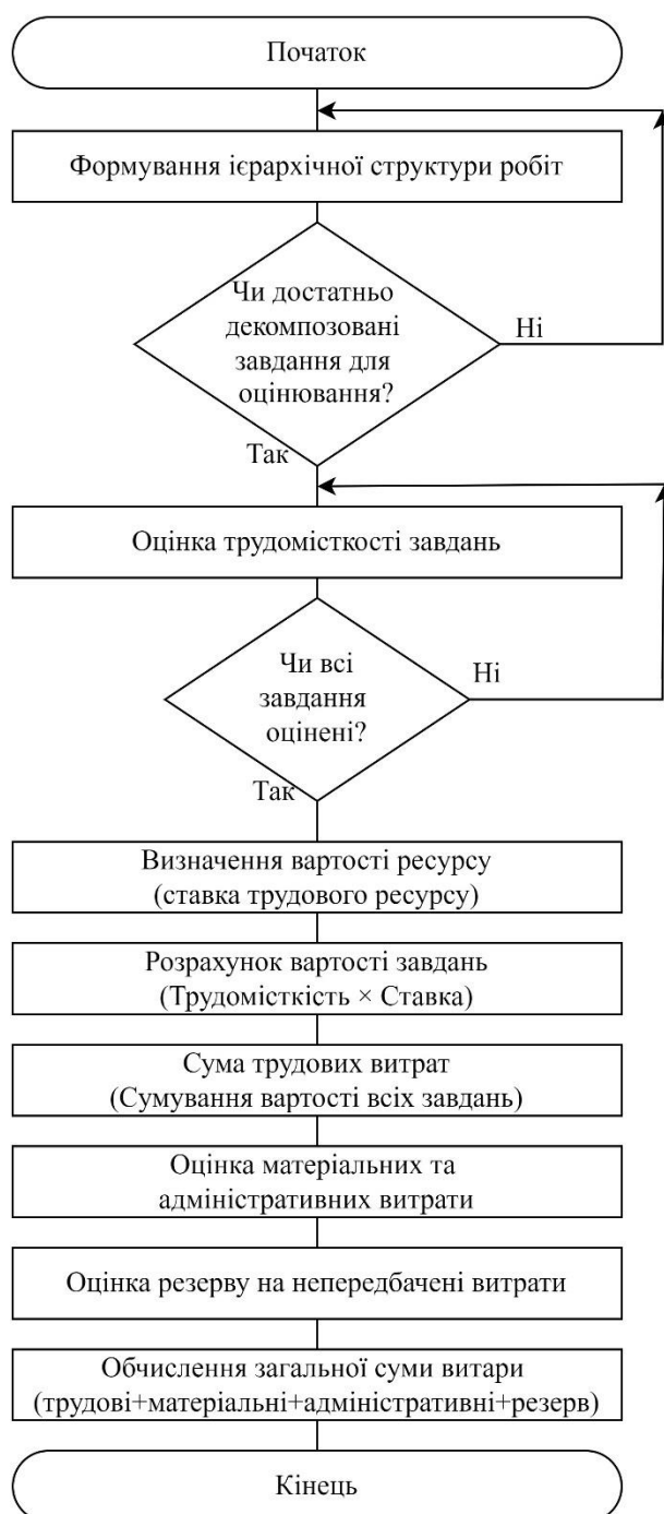
Рисунок 2.2 – Схема алгоритму оцінки вартості проєкту розробки інформаційної системи
