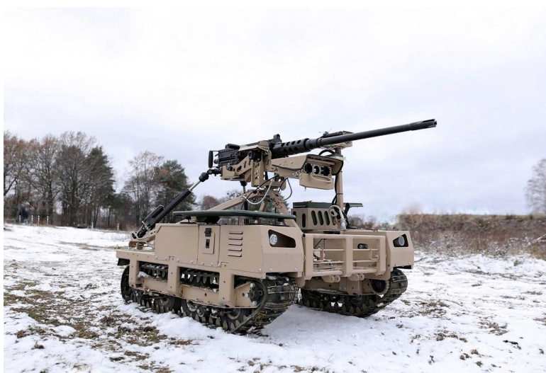
Рисунок 2.6- Наземний роботизований комплекс «Терміт»
