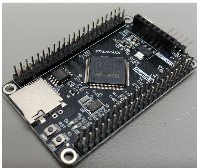
Рисунок 1.6- Мікроконтролер серії STM32F407 від STMicroelectronics
