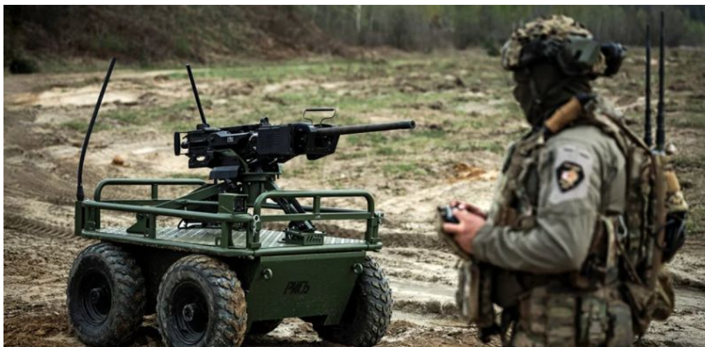
Рисунок 1.5- Колісний безпілотний транспортний засіб ( з дистанційним управлінням башнею кулеметом)
