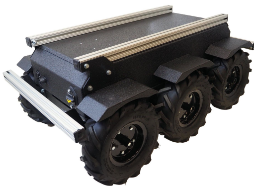
Рисунок 1.13- Платформи типу Skid-Steer
