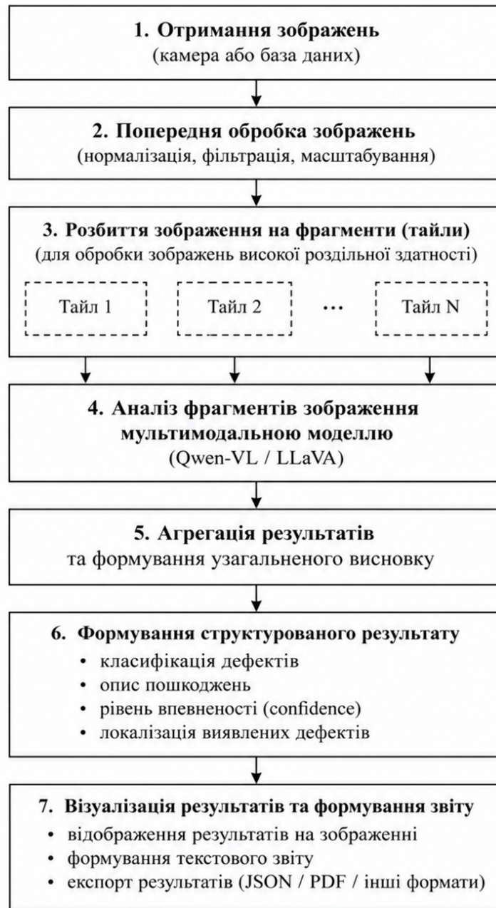
Рисунок 2.1 – Структура системи класифікації пошкоджень бетонних конструкцій
