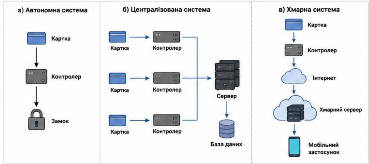
Рисунок 1.3 – Основні архітектури побудови систем контролю та управління доступом
