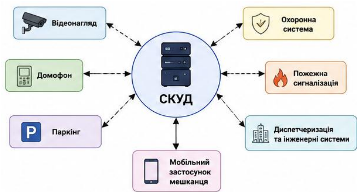
Рисунок 1.4 – Схема інтеграції системи контролю доступу з підсистемами безпеки та сервісами житлового комплексу
