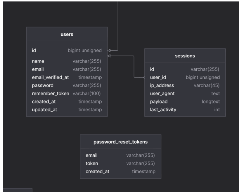
Рисунок 2.5 – ER-діаграма зі службовими таблицями для користувачів
