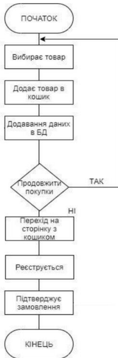
Рисунок 2.7 – Схема алгоритму замовлення товару
