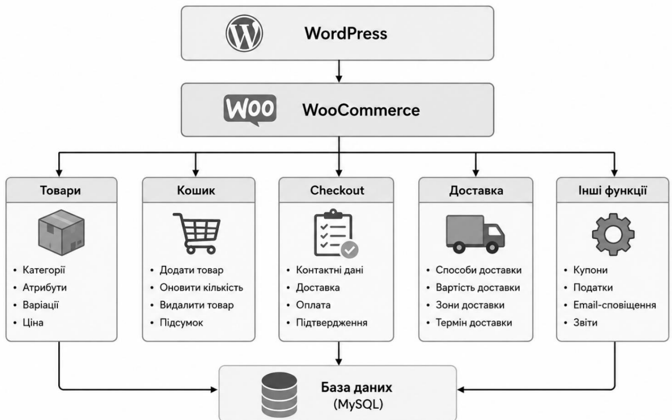
Рисунок 3.1 – Структура налаштувань базових параметрів системи виконання замовлень кондитерських виробів
