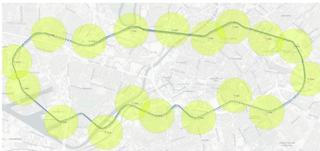
Рисунок 3.10 - Зв'язок "повітря-земля" між обраними шлюзами та БПЛА для фази сканування до оркестрації в CupCarbon
