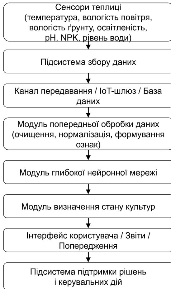
Рисунок 2.1 – Узагальнена схема архітектури інтелектуального модуля моніторингу стану сільськогосподарських культур у теплиці
