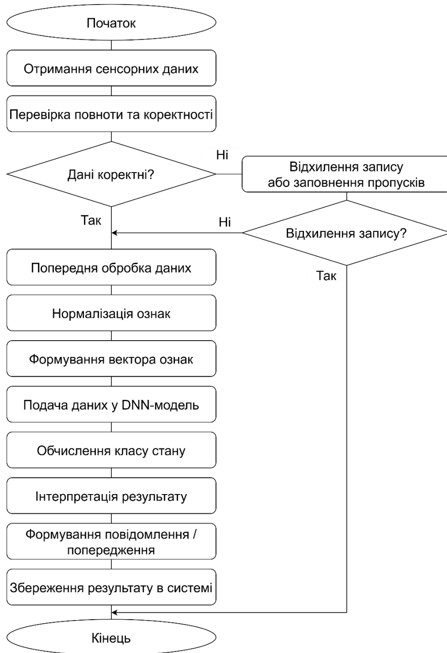
Рисунок 2.6 – Схема алгоритму функціонування інтелектуального модуля моніторингу [33]
