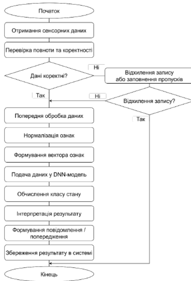
Рисунок 1 – Схема алгоритму функціонування інтелектуального модуля моніторингу
