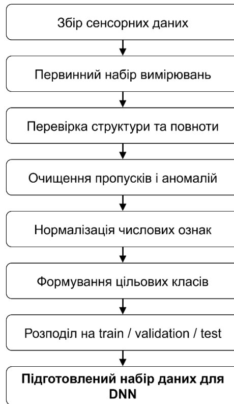
Рисунок 2.3 – Схема формування та попередньої обробки даних IoT-сенсорів
