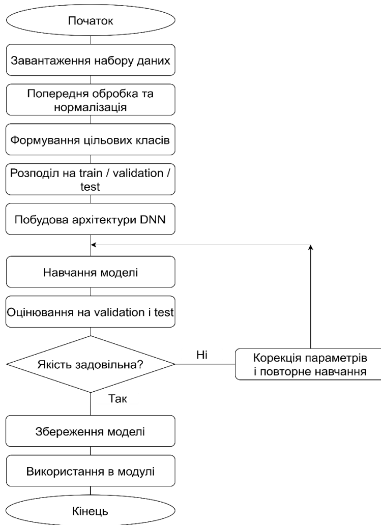
Рисунок 2.7 – Схема алгоритму навчання DNN-моделі для модуля моніторингу
