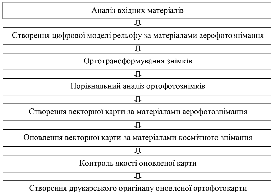
Рис.3.1. Загальна технологічна схема створення та оновлення топографічної карти за матеріалами аерокосмічного знімання [5, с. 33]
