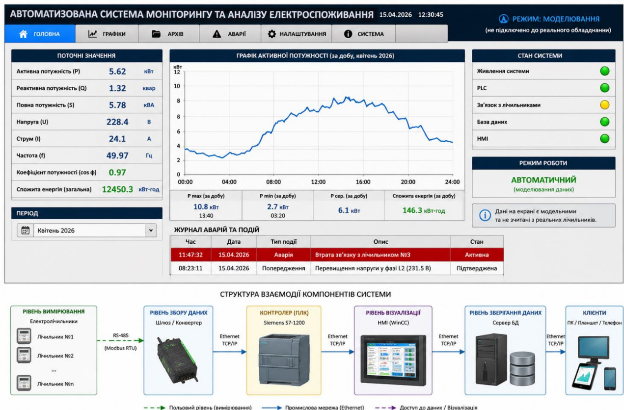
Рисунок 3.14 – Інтерфейс оператора (HMI) та структура взаємодії компонентів автоматизованої системи
