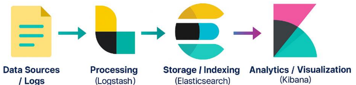
Рисунок 1.2 - Схема обробки та візуалізації даних у Elastic Stack
