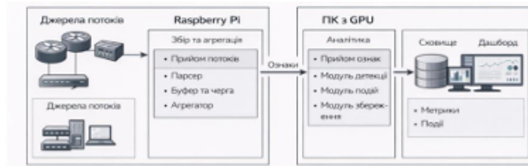
Рис. 1. Структурна схема програмно-апаратного рішення для збору потокової телеметрії
