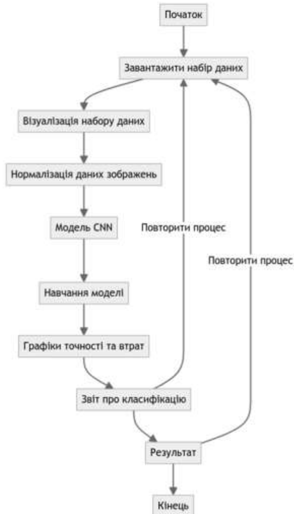
Рис. 1. Алгоритм виявлення тріщин на поверхнях на основі CNN
