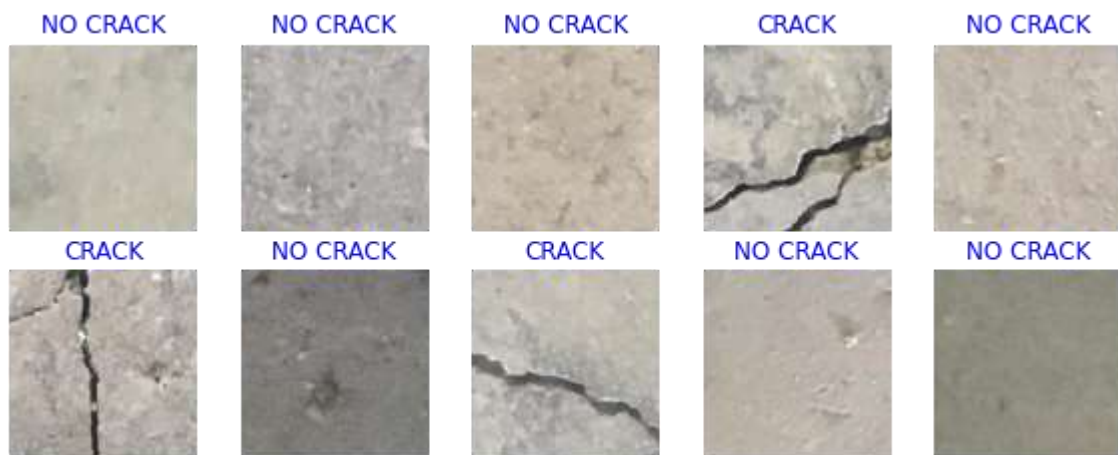
Рисунок 3.7 - Класифікація стану бетонних поверхонь з використанням CNN
