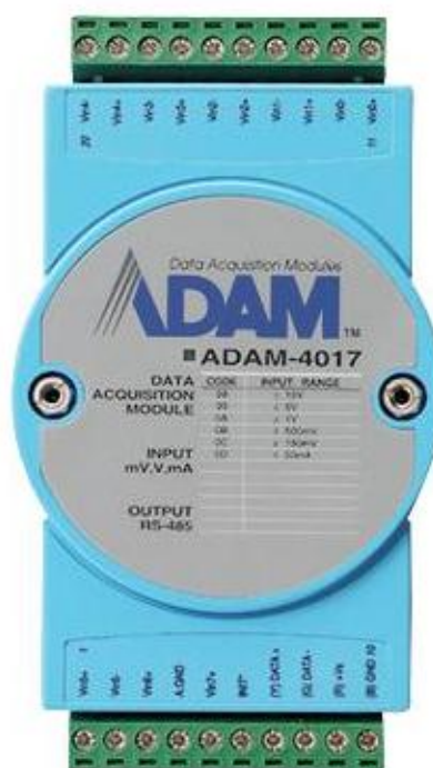
Рисунок 3.8 – Модуль аналогового введення на 8 каналів ADAM-4017
