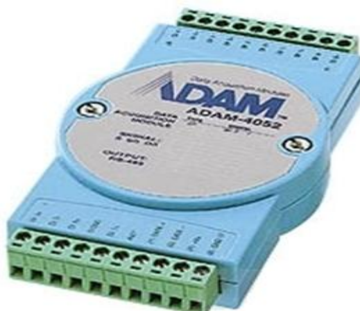
Рисунок 3.10 – Модуль цифрового введення-виведення з гальванічною розв'язкою
