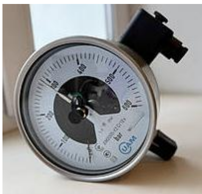
Рисунок 3.3 – Диференціальні мембранні манометри типу ДМ-3583М
