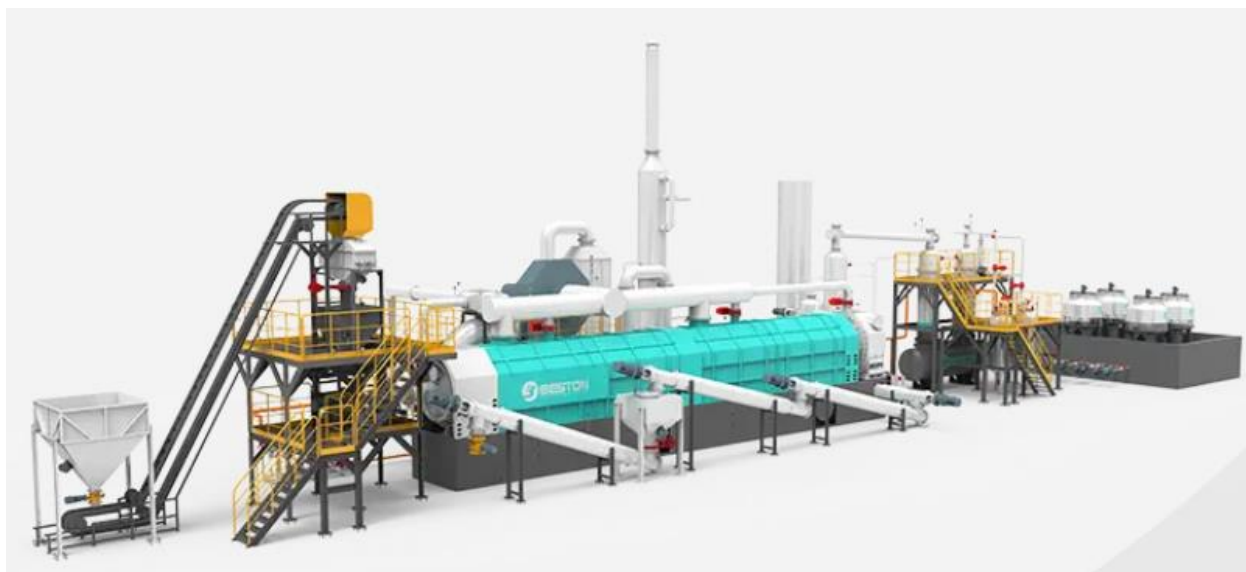
Рисунок 2.1. – Лінія переробки твердих побутових відходів методом піролізу.
