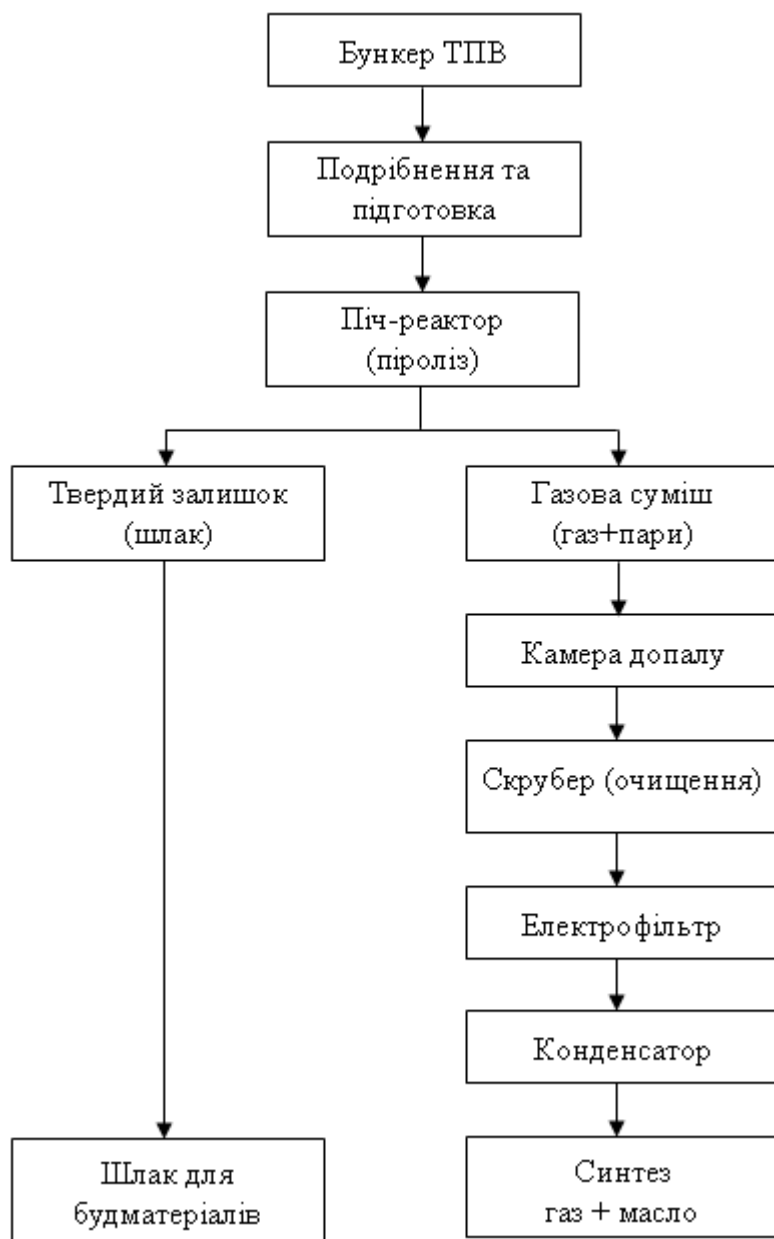
Рисунок 2.1. – Технологічна схема процесу переробки ТПВ методом піролізу.
